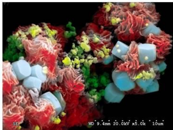
Figura 7. Imagen de microscopía electrónica de barrido de materiales preparados mediante tratamiento hidrotérmal a partir de zeolita tipo Y y surfactantes catiónicos. Color añadido para indicar los distintos componentes: (azul) zeolita, (verde) material amorfo y (rojo) sílice mesoporosa laminar tipo MCM-50.
